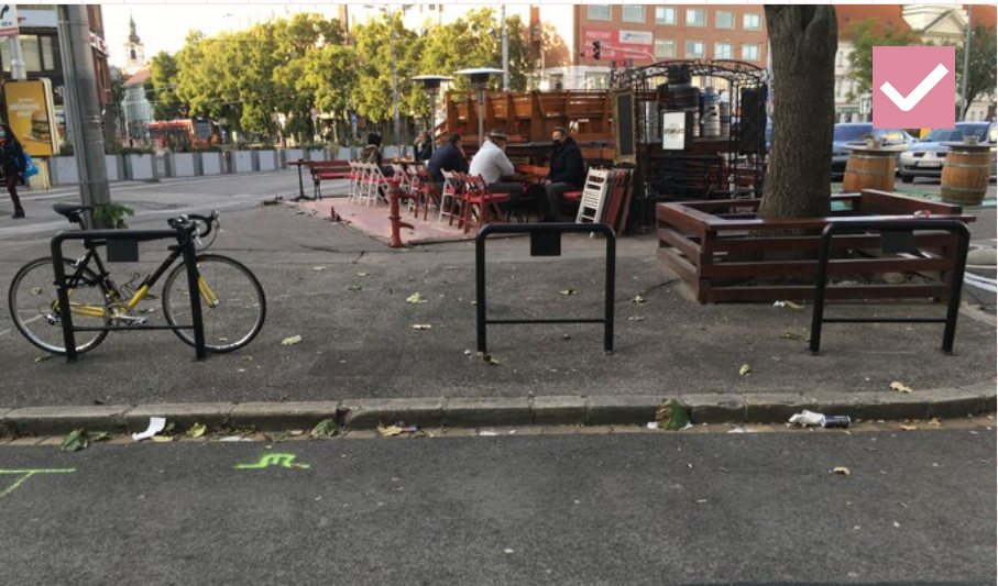
07 Vhodne pozdĺžne osadené cyklostojany nevytvárajú bariéru pre chodcov a zároveň nahrádzajú zahradzovacie stĺpiky. Treba však dbať na rovnomerný rytmus umiestňovania stojanov. Bratislava, Kamenné námestie
